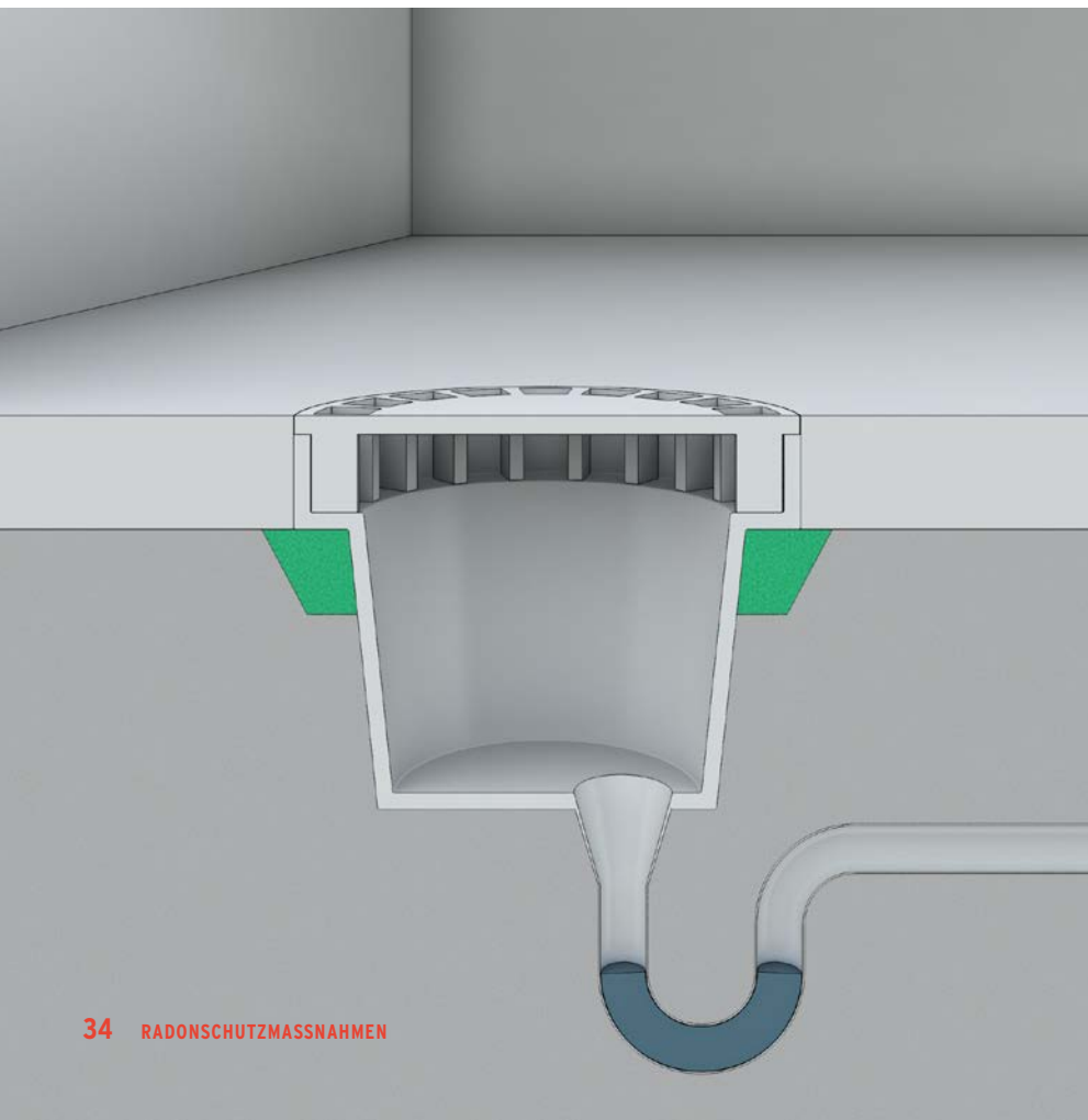
Abb. 7.7: Abdichten eines Bodenablaufs
